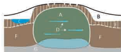
Ryc. 102. Schematyczny przekrój przez palsę. A – torf zamarznięty, B – śnieg, C – woda/lód, D – soczewki lodu, E – torf okresowo zamarznięty, F – torf niezamarznięty, G – podłoże niezamarznięte (wg M. Seppälä)
